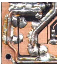
Detail zesílení spojů drátem
